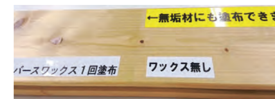
無垢フローリングにリバーシワックスを施工した場合としない場合の比較（中央から左部分が1回塗布、右部分が未塗布）
